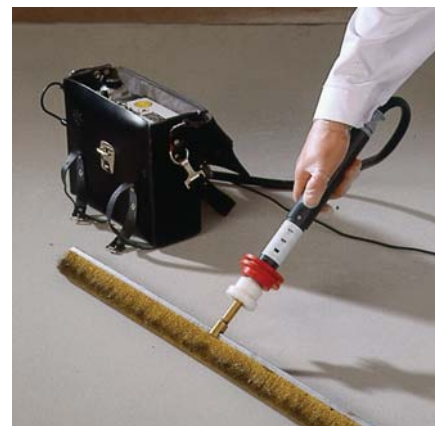
Sprawdzenie szczelności przy zastosowaniu cewki Ruhmkorffa pod napięciem pomiarowym 3600 Volt
